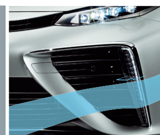
整流効果のある クリアランスランプ形状 Clearance lamps designed to streamline airflow
