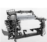
無停止杆換式 豊田自動織機(G型)
