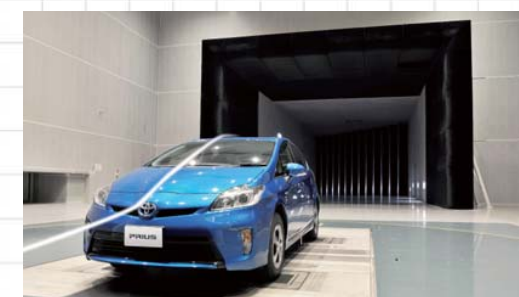
風洞実験棟 車両計測風景
