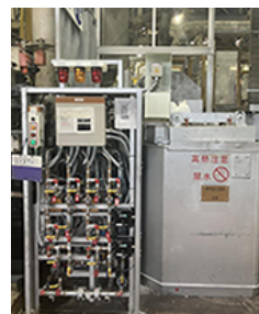
水素燃焼のバーナを使用した熔融金属の保持炉
