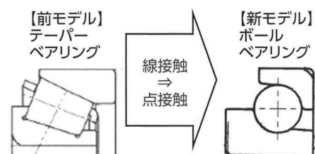
図6 ベアリング変更概要
