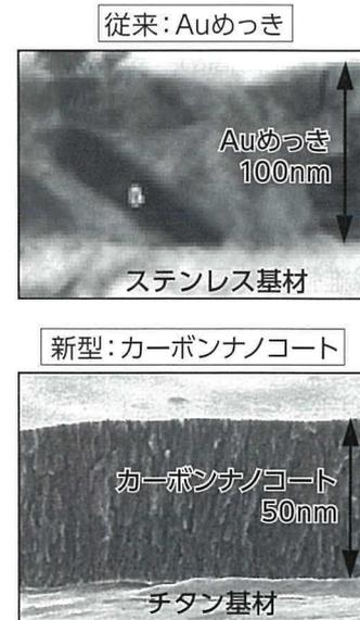
図8 セパレータの表面処理
