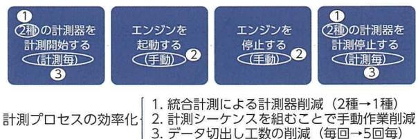
図9 エンジン起動時振動の計測プロセス
