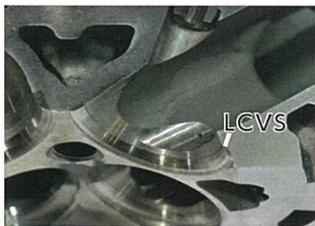
図 1 LCVS を採用した吸気ポート断面
