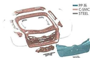
図 2 バックドア構成部品
