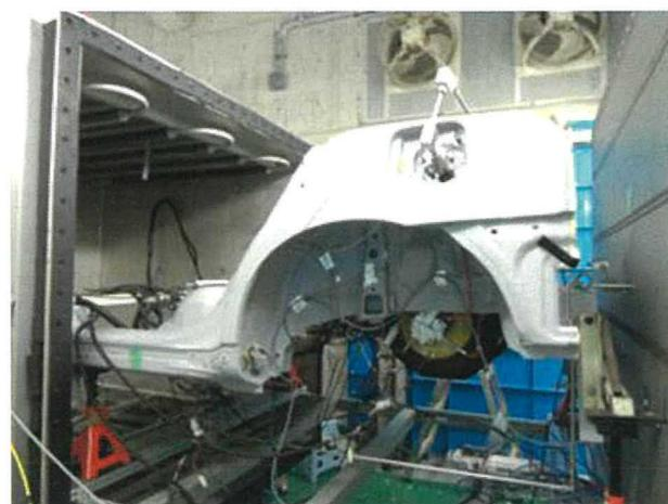
図 27 水素ガス圧力サイクル試験外観
