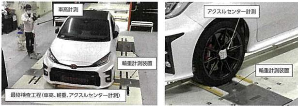
写真8 車高、輪重計測 写真9 アクスルセンター測定
