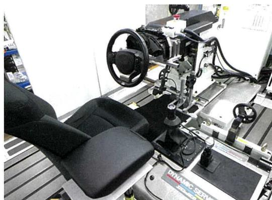
図 13 シフト・クラッチシミュレータ
