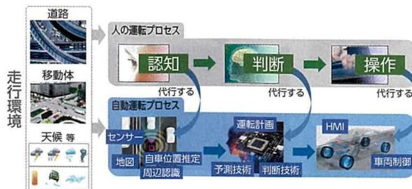
図5 Advanced Drive システム制御の流れ
