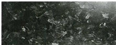
写真 11 SMC 工法による CFRP の外観
