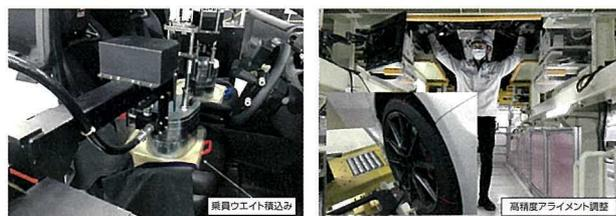
写真6 ウェイト積み込み 写真7 アライメント調整
