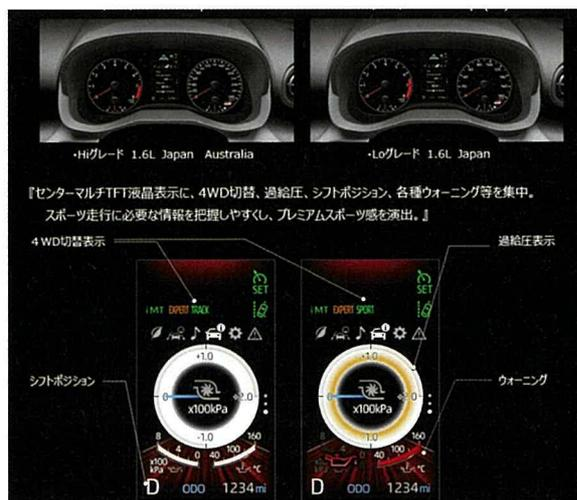
図 14 アナログメーター、マルチ TFT 液晶表示
