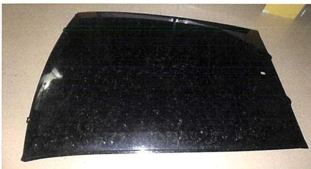
図6 CFRP素材のルーフパネル
