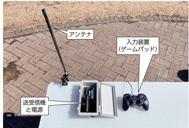
図17 169MHz 操縦装置
