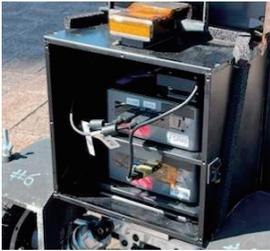
図5 メイン ECU (ECU ボックス内部)
