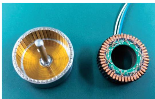
図6 超多極アウターロータモータ
