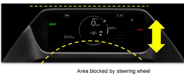
Fig. 25 Visible Meter Area
