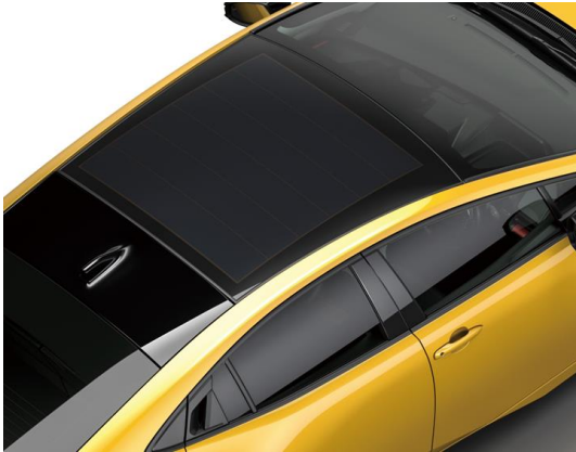
図 58 新型プリウス PHEV のソーラールーフ (2)
