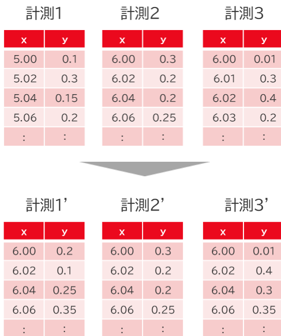
図 11(b) 複数の計測データの成形前後の比較
