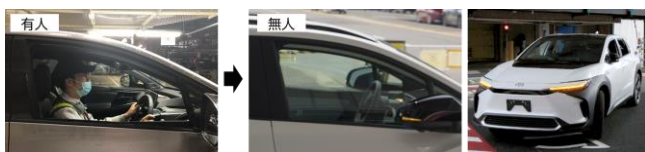
図 1 RCD による車両無人搬送の様子
