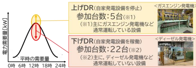
図10 デマンドレスポンス参加自家発電設備
