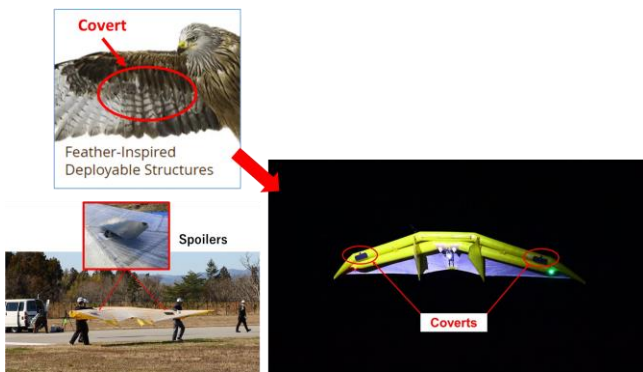
図 21 新導入空力舵(猛禽類コバート翼模擬) (18)
