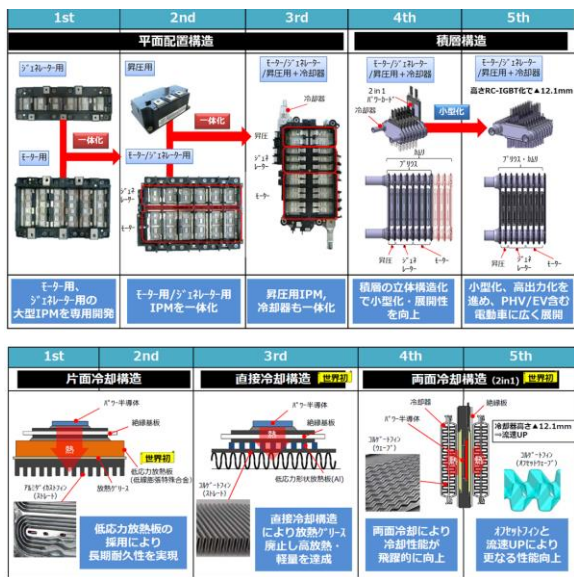
図 16 パワーモジュールと冷却構造の進化
