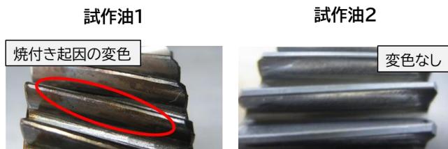
図 11 高速耐久試験後のプラネタリサンギヤの状態
