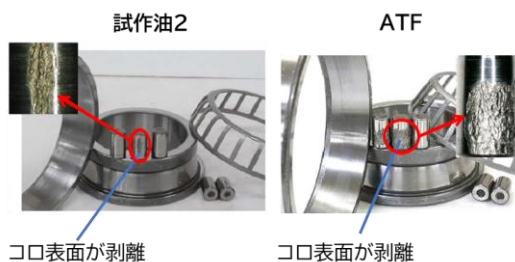
図 6 軸受寿命試験後の疲労剥離部位
