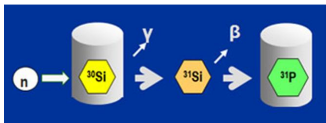
図 11 NTD 法による不純物濃度制御の原理
