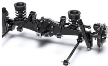
図 9 トレーリングリンク車軸式リアサスペンション
