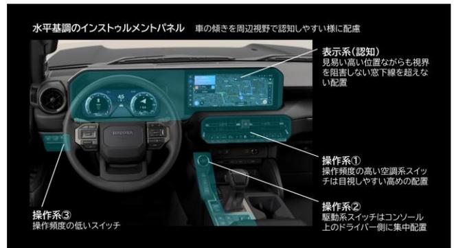
図 29 室内部品の適正配置
