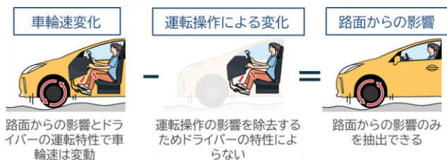
図2 車輪速変化による路面からの影響を抽出する仕組み
