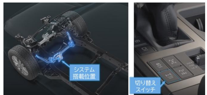
図 2 システム搭載位置と切り替えスイッチ
