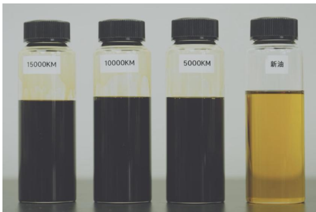
図 1 新品と 5,000km~15,000km 走行後のエンジンオイル
