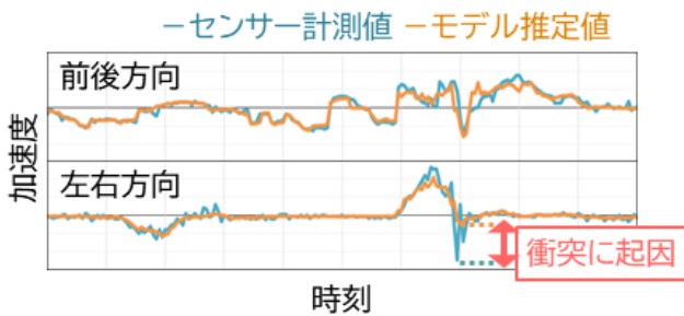
図1 加速度推定モデルを用いた衝突検知
