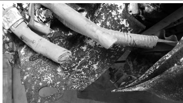
ニブラ等重機を用いて駆動用バッテリーを取りはずしたため、駆動用バッテリーが破損・変形したもの
