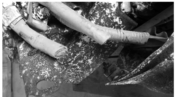
高電圧回路のケーブル類(オレンジ色)を切断したものの
