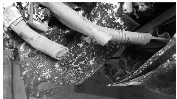
ニブラ等重機を用いて駆動用バッテリーまたは自動運転用バックアップ電源を取りはずしたため、駆動用バッテリーまたは自動運転用バックアップ電源が破損・変形したもの
