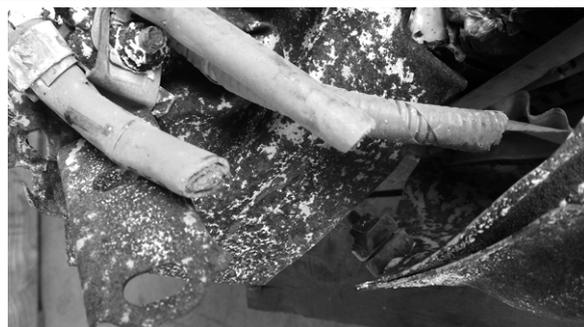
ニブラ等重機を用いてHVバッテリーを取りはずしたため、HVバッテリーが破損・変形したもの
