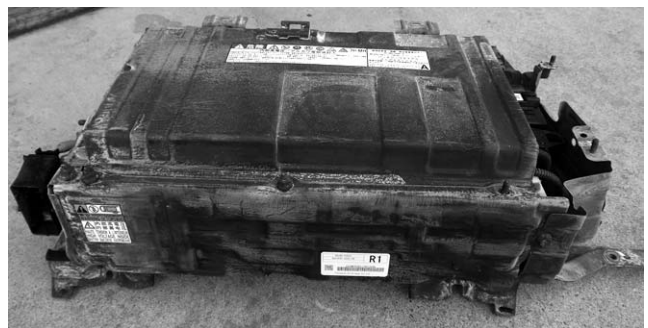
屋外に長期間放置されて損傷が激しいもの
