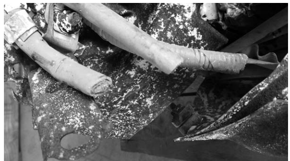
高電圧回路のケーブル類(オレンジ色)を切断したもの
