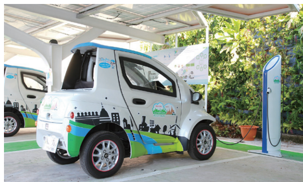
駐車場屋根に設置した太陽光パネルで発電したCO 2 フリーの再生可能エネルギーを利用して「Ha:mo」を充電
