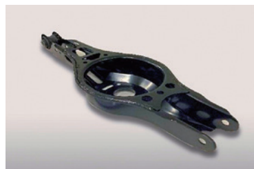
東京製鐵株式会社から供給された日本国内の鉄スクラップを100%使用したりサイクル鋼材で作られたサスペンションロアアーム。従来の天然資源由来の鋼材と比較して、CO 2 排出量を製品1トン当たり5分の1程度に抑えることができる
