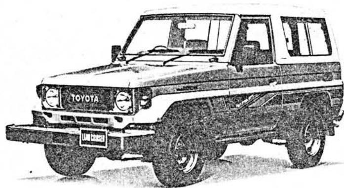
ランドクルーザー 70系 FRPトップ車 (N-BJ73V-MN(W)) '84.11 メカニカルウィンチ装備車、ハロゲンヘッドランプ、ヘッドランプクリーナー、傾斜計&高度計、サイドストライプ、メッキホイールはオプション、ウィンチアンダーカバーは販売店装備オプション
