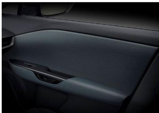
レーザーカットによるグラフィックを施したドアトリム表皮
