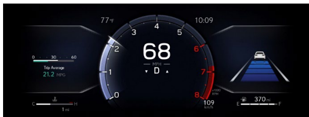
LEXUS 12.3 インチフル液晶メーター（プロトタイプ）
