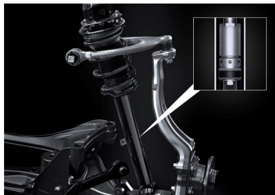
LEXUS IS 内蔵式リニアソレノイドアクチュエーター（プロトタイプ）
