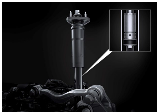
LEXUS IS 内蔵式リニアソレノイドアクチュエーター（プロトタイプ）
