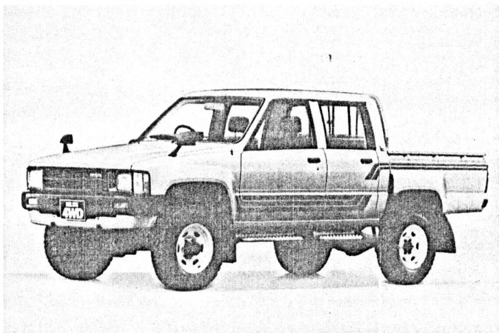
ハイラックス 4X4 ダブルキャブ SR (N-LN65-MSP) '83.11 215R15タイヤ & ホワイトスポーツホイール、オートマチックロックリングハブ、傾斜計 & 高度差計 はオプション
