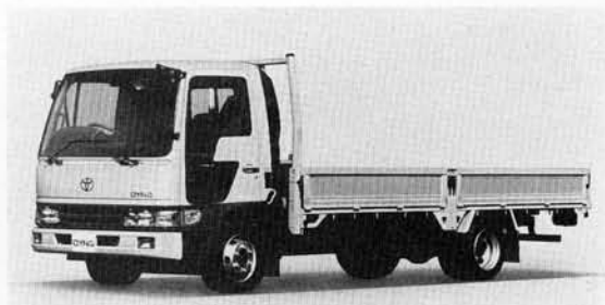
ダイナ グランキャブ 木製超ロングデッキ フルジャストロー 3.5トン積 ディーゼル車 [KC-FB4JGAT-BB]
